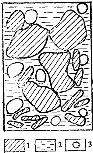
图 1-1 土的三相组成示意 1. 固体颗粒；2. 水；3. 汽泡
