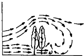
图 4 通风结构林带防风特性示意图
