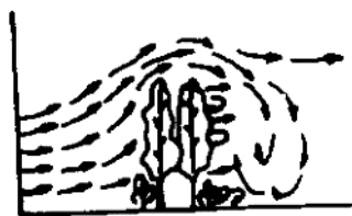
图 3 疏透结构林带防风特性示意图
