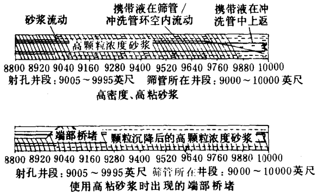
图3 砾石颗粒均匀地分布在高粘砂浆内。在长井段内，粘度差异和密度差异使顶替液在井筒上侧顶替的砂浆较多。砂丘不高。由于砂浆粘度与携带液粘度比值较高，上端可能出现桥堵
