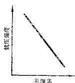
图 1-2 材料强度与孔隙率的关系
