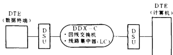
图 1—4 回线交换网的构成图
