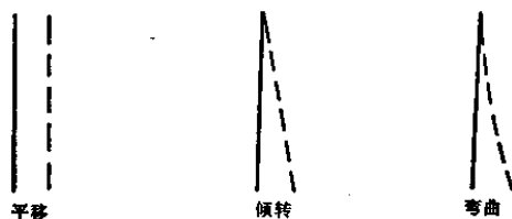
图1-3 支柱的几种理想变形模态
