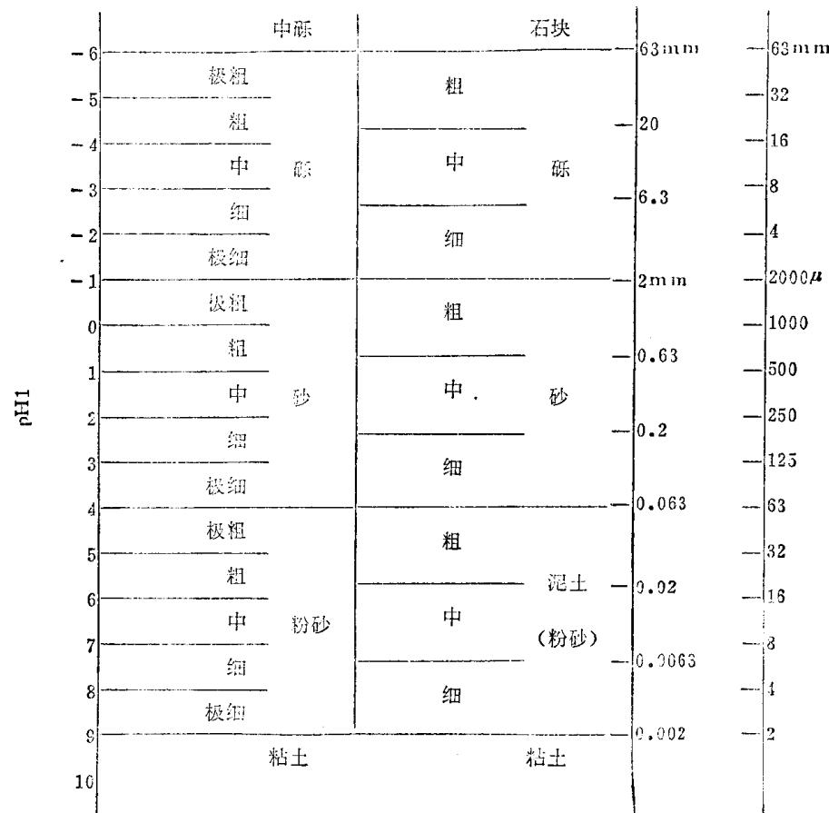
图 2—1 粒度术语。左侧为经道格拉斯(Doeglas, 1968)修改后的温德华粒级，右侧为德国使用的DIN4022粒级
