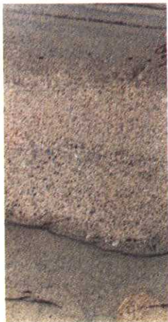
图2 锦2—8—011井沙三段，浊流机制浊积岩，正递变(A)段和平行层(B)段清晰。
