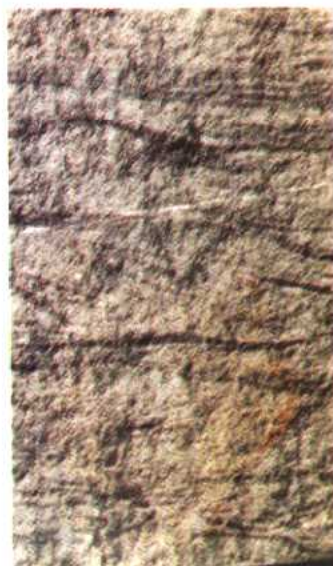
图3 前31—45井2296 m含泥细砂岩中发育波状交错层理，局部有爬升现象。
