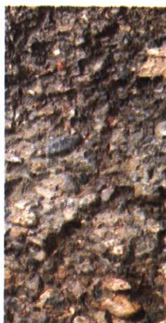
图6 兴4-22井沙三上,碎屑流机制浊积岩,呈基质支撑的“混凝土”状块状体。
