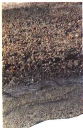
图1 锦2—8—011井沙三段，下部为细砂级正递变段，中上部为细砾级正递变段。
