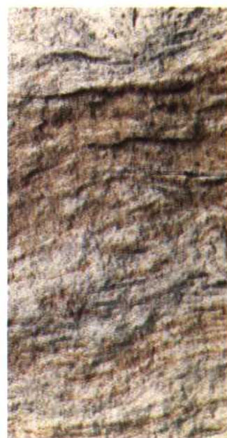
图3 清5井东二段,褐灰色含油细砂岩,具不规则的波状交错层理。
