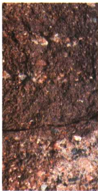
图1 洼12井东营组,冲(洪)积扇沉积,由颗粒粒级变化和定向排列显示的平行层理。
