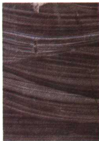
图6 海20—30井1806m，含油细砂岩显示典型的槽状交错层理。
