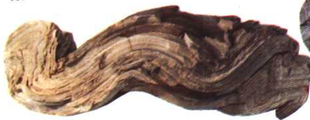
图7 曙4—6—07井沙四段，黄褐色含钙油页岩，页理发育，塑性变形呈连续褶曲状。
