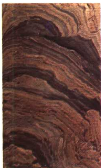
图4 曙13井沙四段，灰黄色钙质页岩，固结前的塑性变形使细层弯曲，固结后局部产生断裂。
