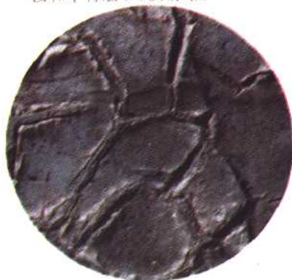
图5 杜126井3222m，褐灰色含粉砂泥岩见水下收缩痕，裂纹中充填泥质粉砂。
