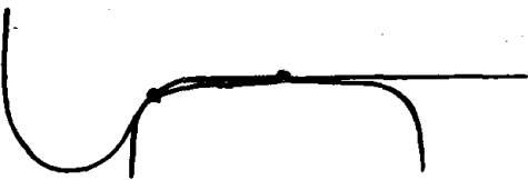
图 1—7 TB 型踏面与钢轨的二点接触
