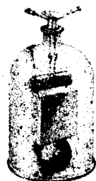
第1圖 置于真空波罩內的電鈴聲音是聽不見的
