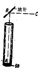
第2圖 聲音在45°玻片上之反射
