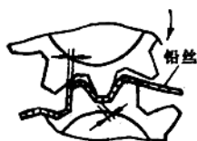
图 12-3 压铅丝法检查
