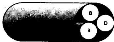
图1.1 基本速率ISDN在同一线上提供三个通信信道
