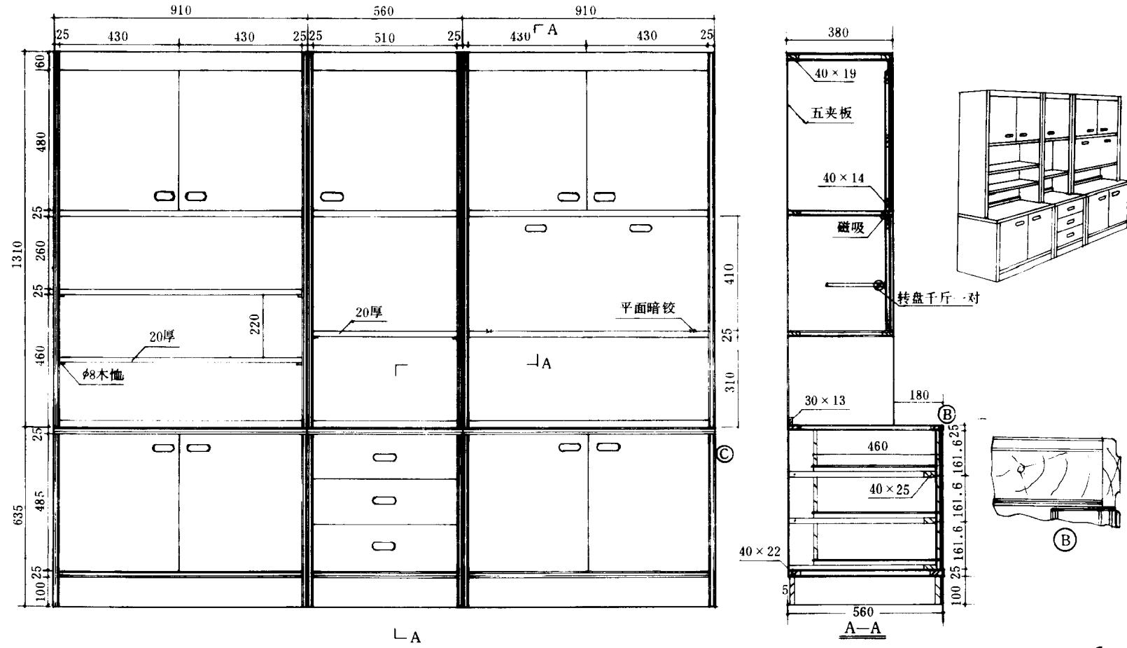
组合酒柜由左、中、右三个柜组成。三个柜的上架掩门内和下柜容量较大，可以贮藏较多的食物及餐具。左柜上架的层板上可摆设小型工艺品，取下层板上架可用于放置电视机。中柜上架的层板上可摆设小型盆景，以点缀客厅。右柜上架将掩门翻下可用于放置饮料、器皿。
