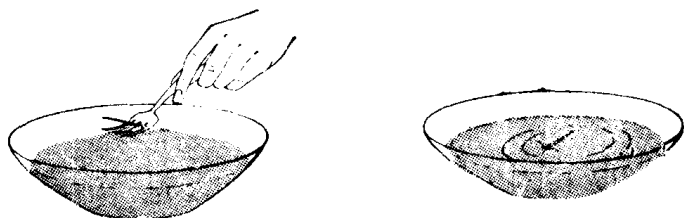
图 1-5 阿基米德定律与其他许多定律一样，其适用范围是有限的。假如用叉子很小心地把针放在水面上，针将会浮在水面上。这个现象不能用阿基米德定律来解释，它是由于水的表面张力而引起的
