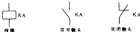
图 1-18 电磁式继电器图形、文字符号
