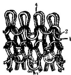
图9 提花毛巾布的线圈结构
