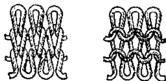
图2 纬平针织物的结构图
