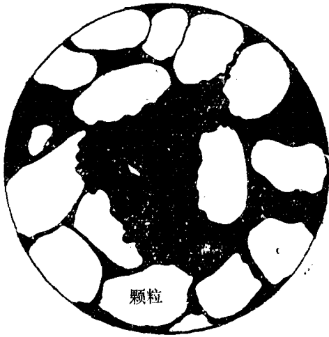
图 1-5 砂岩内溶孔的典型特征示意图 (图中黑色区为溶孔、颗粒具港湾状边缘)
