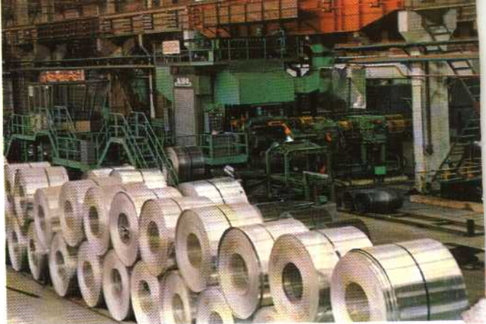
1. 王果青经营的东北 轻合金加工厂的铝 材冷轧生产线
