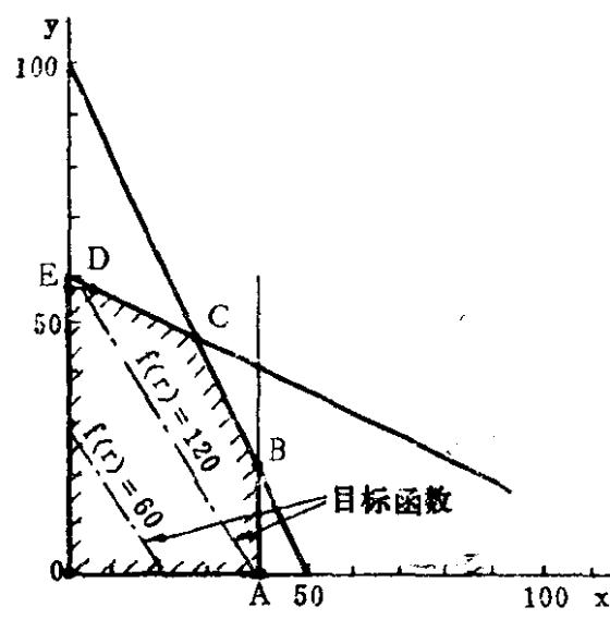
目标函数是一次方程式，即是一组具有相同斜率的直线，其中包含在该多边形的范围内，且距原点最远的顶点就是最优解，在此图的情况下就是凸多边形的顶点 C。除去在约束条件中包含有某种矛盾，
