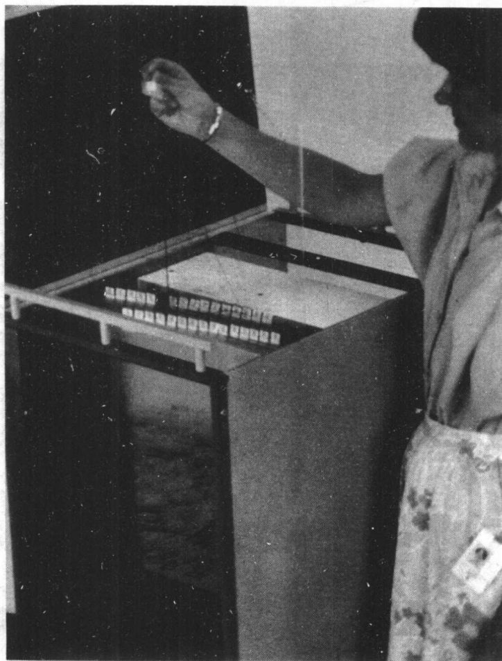
图 1-12 地震模型显示装置,属于真实三维显示方法之一
