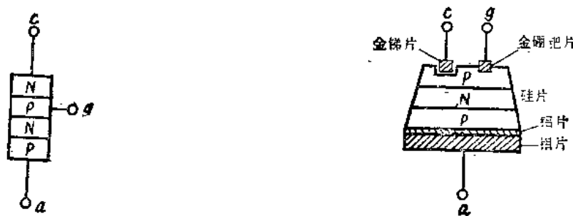
图 2-2 可控硅元件的内部结构 (管芯)
