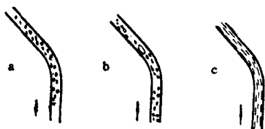
图 1-5 气水混合物向上流动转弯 45^\circ 时的流型
