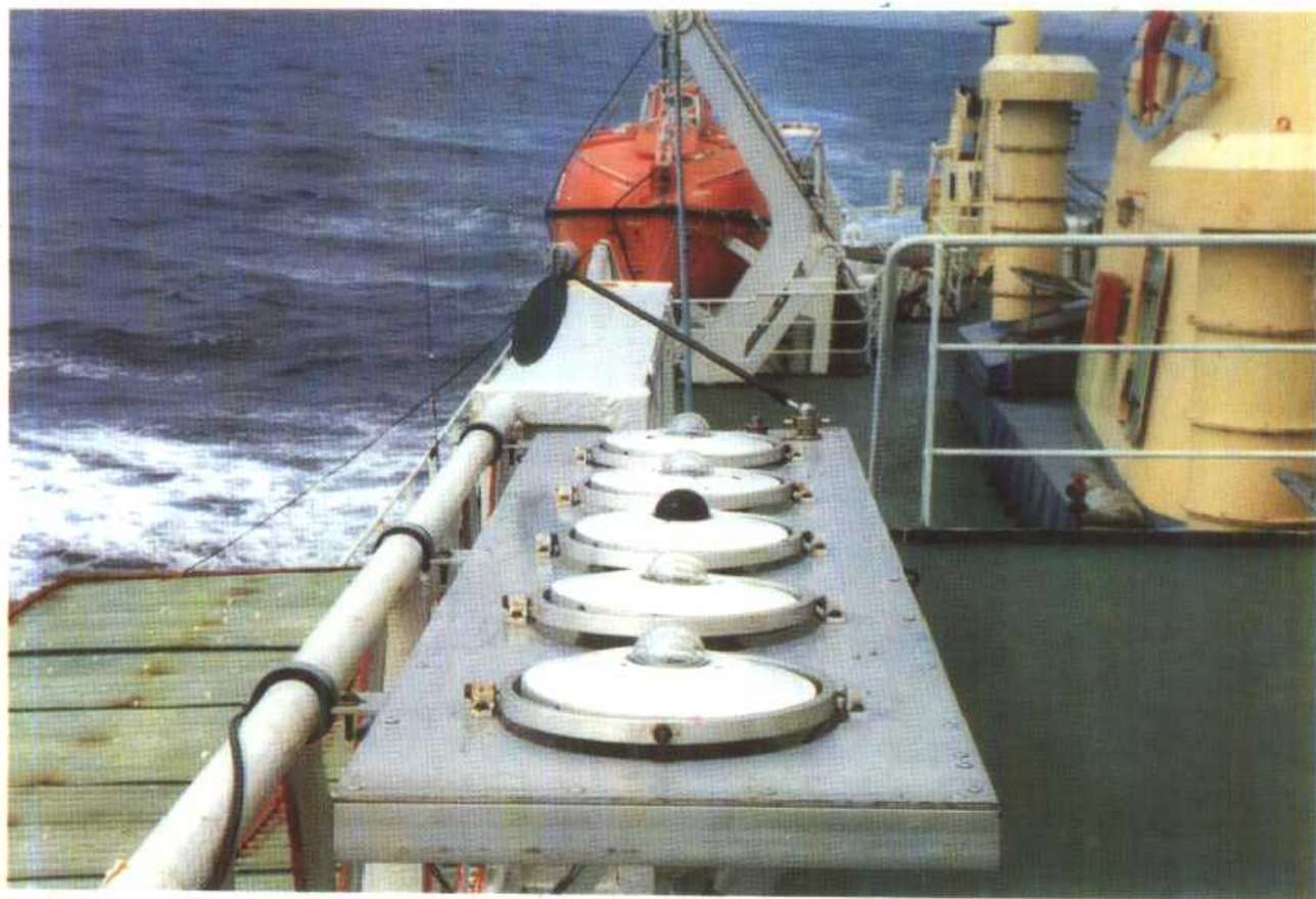
图1 太阳直接辐射、总辐射、散射辐射及分光谱辐射 观测仪器。(中国科学院地理研究所徐兆生 摄)
