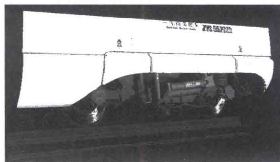
图 2-7 TEDS-3D 采集侧部裙板图像
