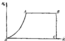
图 1—17 电涡流测功器的特性曲线
