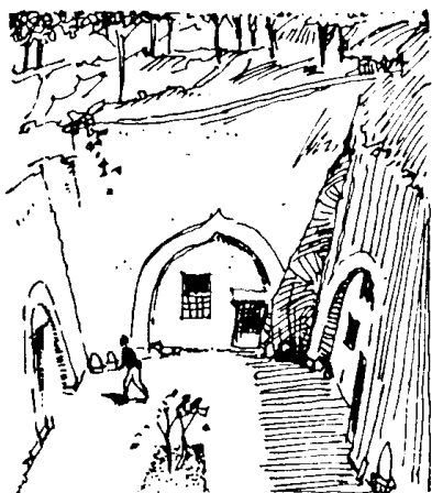
黄土高原的窑洞利用厚实的土层，隔热防寒很适合干旱寒冷地区人的居住要求
