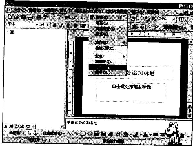
2. 打开【自定义】对话框，在对话框中打开【工具栏】选项卡，在【工具栏】列表框中，可单击选中工具栏左边的复选框以显示此工具栏，或者取消该复选框以隐藏该工具栏。如右图单击【绘图】复选框。
