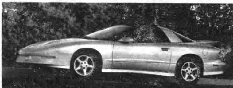
是旁蒂克值得自豪的车型之一，塑料车身和后固定轴驱动的汽车。既有顶部取下的双门轿车，也有双门敞篷小轿车。
