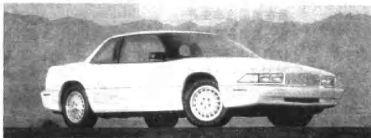
1988年推出，是纯美式中型车路线，外形美观。其高级款型搭载的3.8L V6引擎，是美制传统OHV引擎中的极品。
