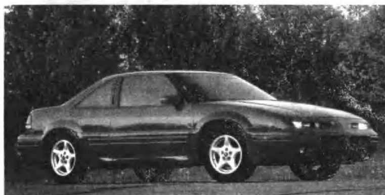
主力中型运动房车，和雪佛兰鲁米娜、奥斯莫比超级一起同属 GM10 计划。有 4 门和 2 门两种款式顶级 GT 型的 3.4L V6 引擎是北美 DOHC 引擎的先驱。
