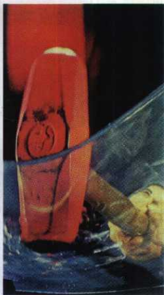
抗高压塑料的强度可与 钢铁相比，在铁锤的重击下 它毫无损伤
