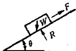
图1 切向及垂直于斜面的力的平衡关系
