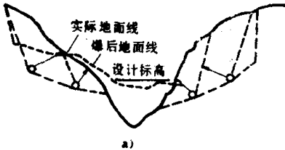
图 1-1-4-6 倾斜地形的定向爆破 a) 60t 双侧定向爆破中心剖面图; b) 沟中心剖面图
