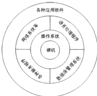
图 1-17 操作系统与软、硬件系统的关系示意图
