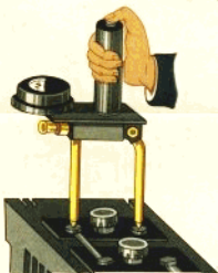
测量蓄电池的端电压
