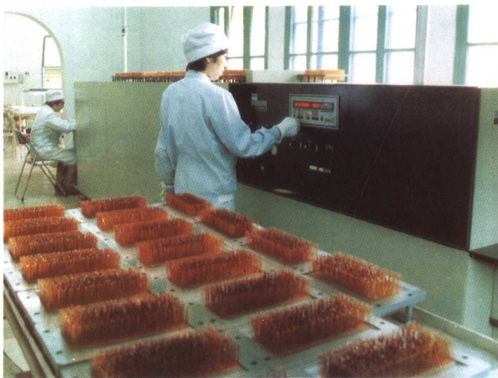
硅二极管生产工序
