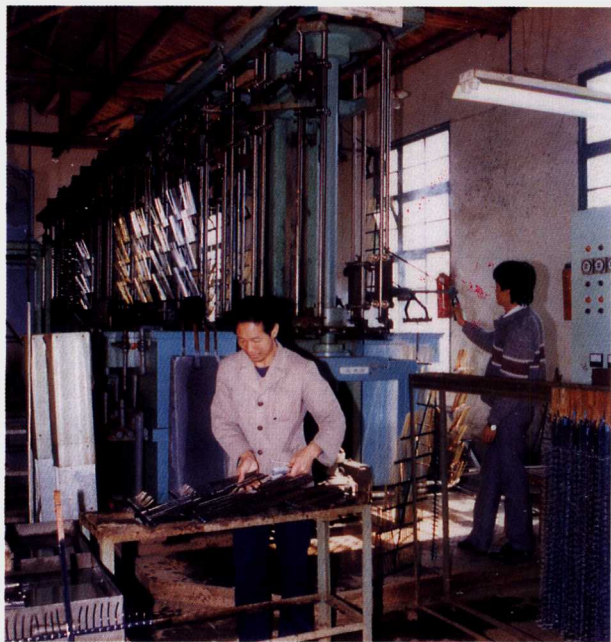
南平无线电一厂拉杆天线电镀工序
