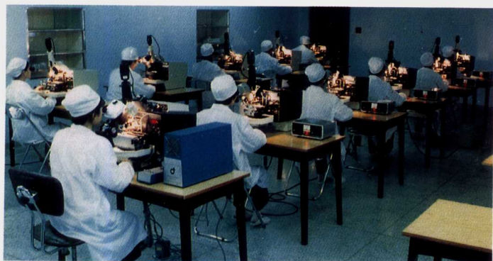
南平五〇四厂集成电路后工序
