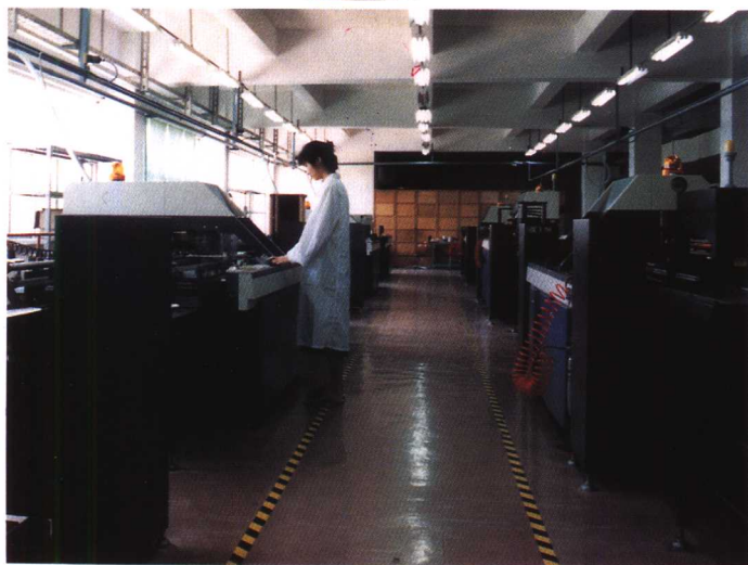
录像机生产线电脑自动插件机
