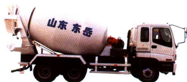
混凝土搅拌运输车
