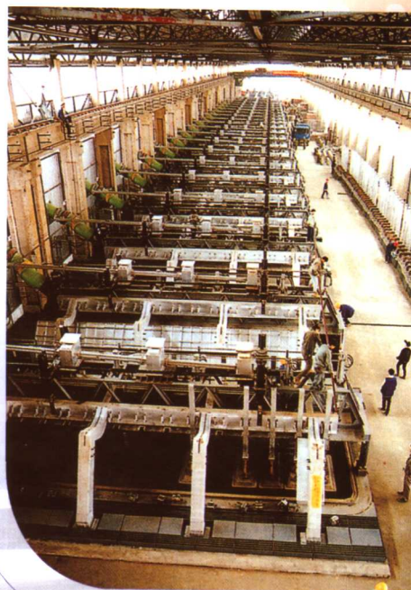
国内一流，国际先进， 年产10.5万吨的186KA 铝电解生产线
