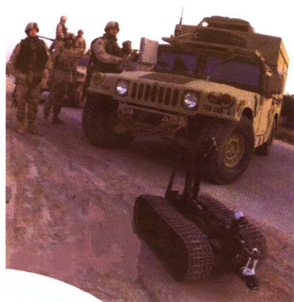
美国陆军驻伊部队装备的用于探测并引爆改进型爆炸装置的遥控机器人
