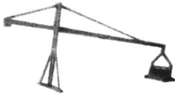
图 0-5 吊篮工作原理
