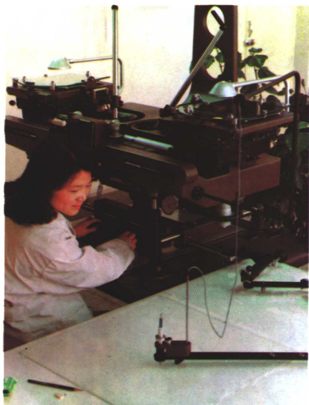
精密立体测图仪在进行航测地形图测绘。
