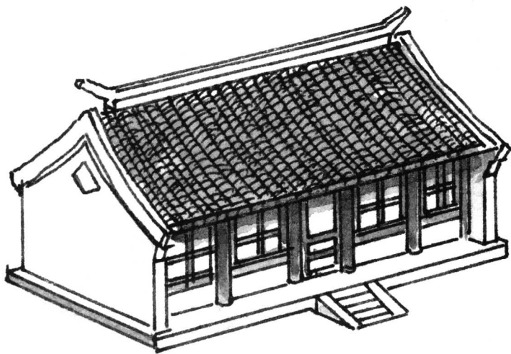
硬山顶，只有与两边山墙齐平的两坡屋顶形式，多见于明清时期南北方住宅中。
