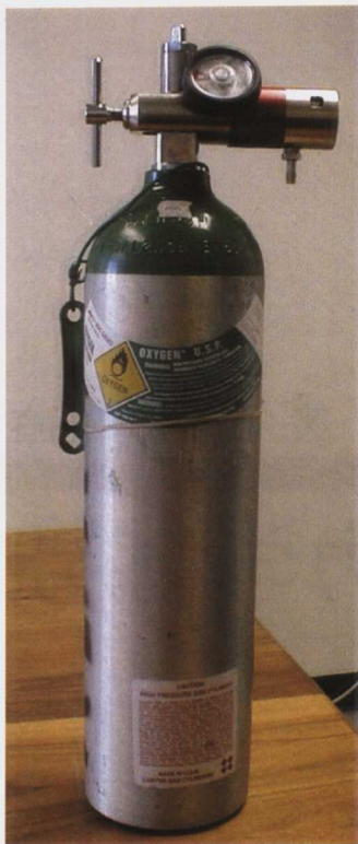
图9-1 读出氧气瓶上的压力表读数,再根据瓶上标注的氧气瓶容积以及当时的温度,可以估算出氧气的用量
