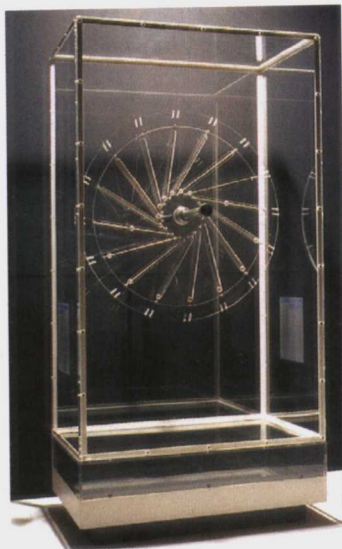
图 9-11 历史上曾经有过的“第一类永动机”模型. 设计者试图利用左右两侧摆锤产生力矩的不平衡使轮子转动, 以达到永动目的. 请读者分析: 系统是否真的能始终处在不平衡状态呢?
