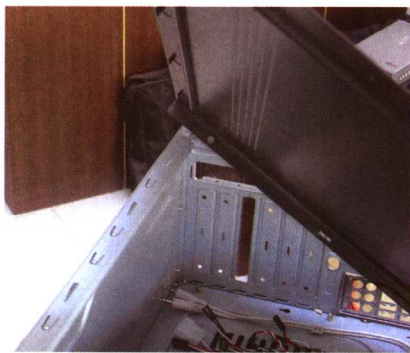
图 1-17 机箱侧板倒钩和箱体的钩槽
