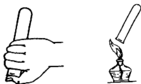
I. 用拇指堵住集满氢气的试管口 II. 靠近火焰,移开拇指点火
