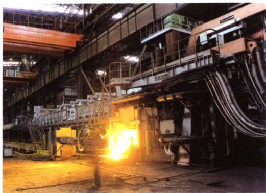
图 6 从意大利 引进的具有世界先进 水平的康斯迪电炉
