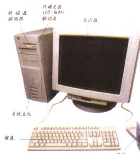
个人计算机包括三个主要部分：输入设备（如键盘、鼠标、扫描仪等），输出设备（如显示器、打印机等），系统部分（包括主要电子元件）。
