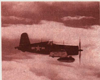
“海盗”机身前部的中轴线上有个178加仑的外挂油箱，可携带1000磅炸弹
