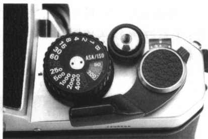
图 1-1 照相机上各级快门速度 (陈喆 摄影)
