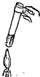
图5. 加热盛液体的试管法。
