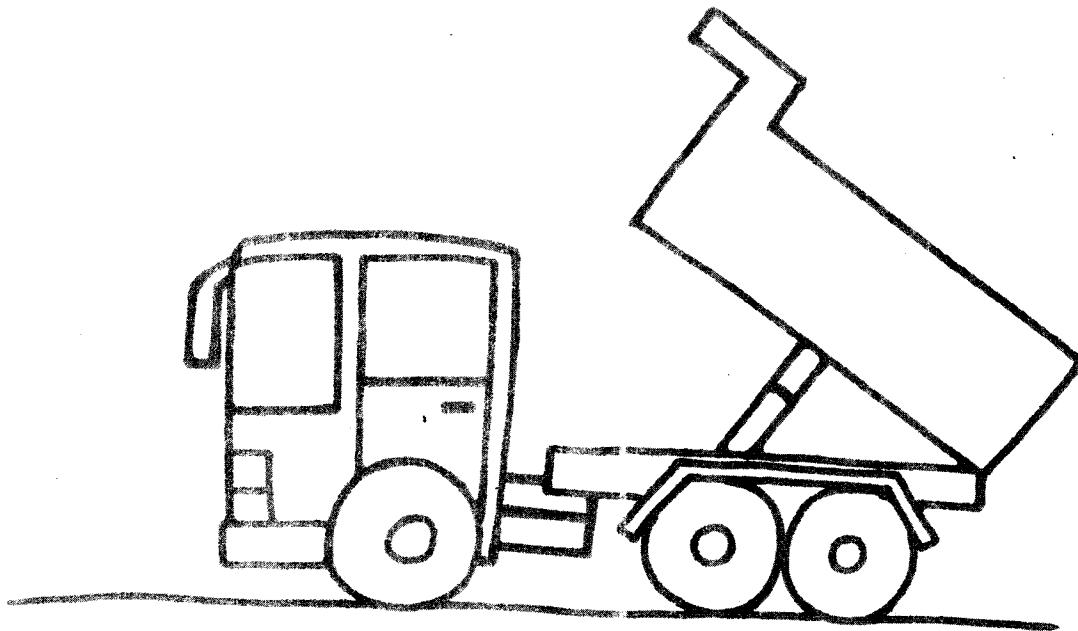
翻斗车具有举升货厢的倾卸装置，可使车厢倾斜卸货。使用翻斗车装运矿石、煤炭、砂石等等，可节省卸货的人力，缩短卸货的时间。
