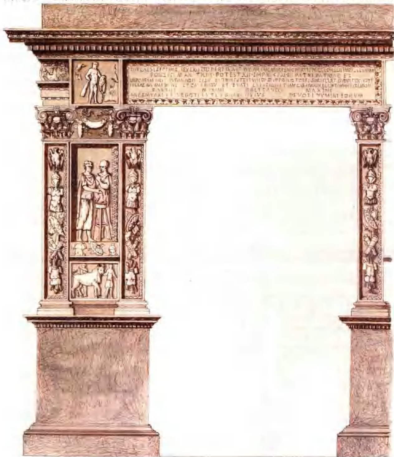
石横梁，古罗马建筑立面局部。
